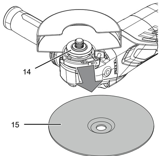
5. Posare il disco separatore (15) sulla flangia di alloggiamento (14). La scritta deve essere rivolta verso il dispositivo. Fare
