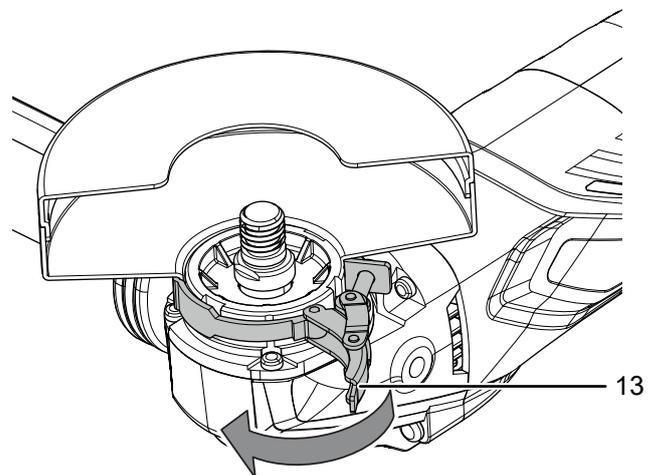
4. Controllare che la cuffia di protezione (9) sia stata bloccata correttamente. Non deve essere più possibile ruotare la cuffia di protezione.
