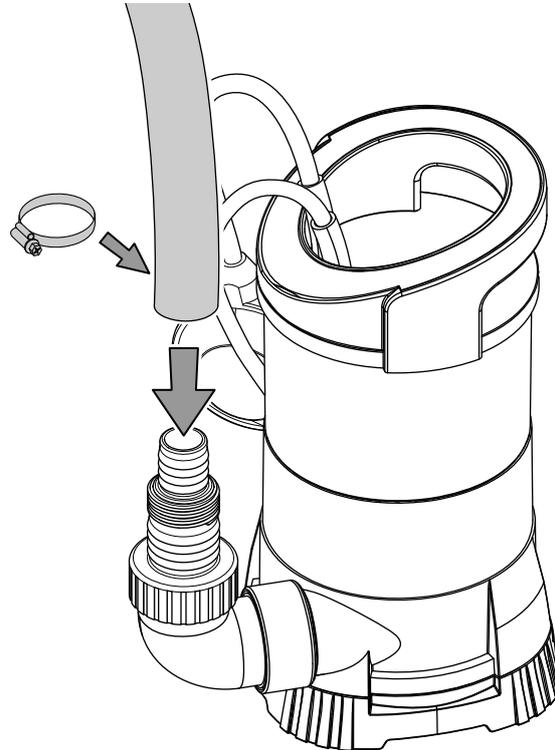
7. Fixieren Sie den Schlauch mit der Schlauchschelle.
