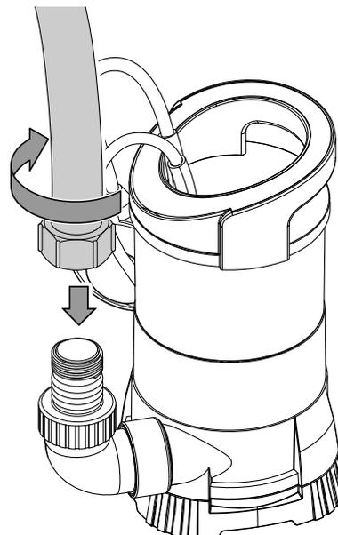
9. Alternativ können Sie einen Schlauch mit Innengewinde (1 1/2") direkt auf den Winkeladapter (8) schrauben.
