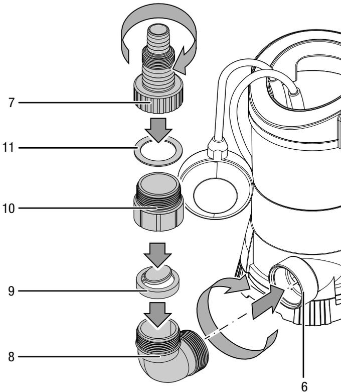
6. Schieben Sie den Schlauch (Innendurchmesser 25 mm oder 32 mm) bis zum Anschlag auf den Reduzieradapter (7).
