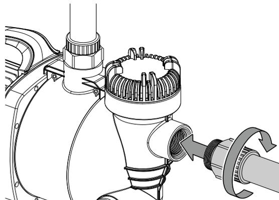
3. Plongez l'ouverture de la conduite d'aspiration dans le point de prélèvement et assurez-vous qu'elle soit toujours suffisamment immergée.
