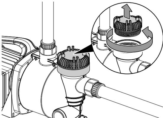
2. Remplissez l'appareil à ras-bord avec le liquide à pomper par l'intermédiaire de l'orifice de remplissage (3). La conduite d'aspiration raccordée doit également être entièrement remplie de liquide.
