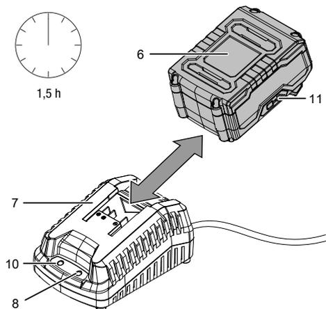
2. Inserire la spina elettrica del caricatore rapido (7) in una presa di corrente assicurata correttamente.
