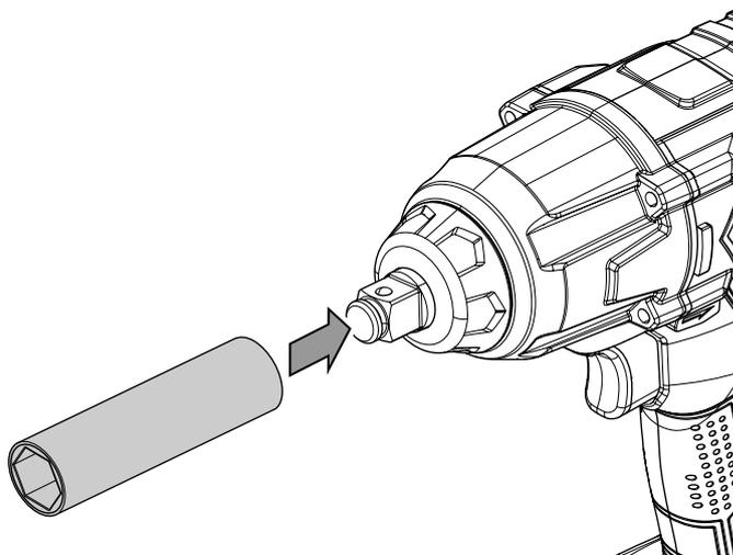
4. Controllare che l'attacco (9) sia posizionato correttamente.
