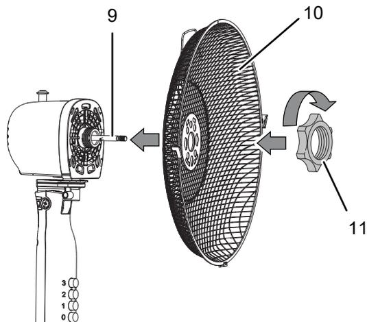
**Fissaggio del volano sul mandrino del motore**
