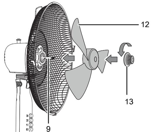
**Montaggio e chiusura della griglia di protezione**
