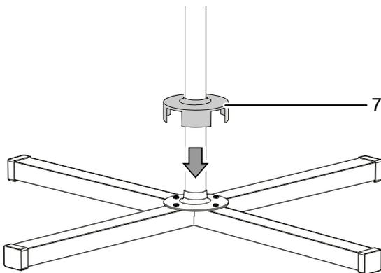
**Collegamento dell'elemento di comando e del supporto**
