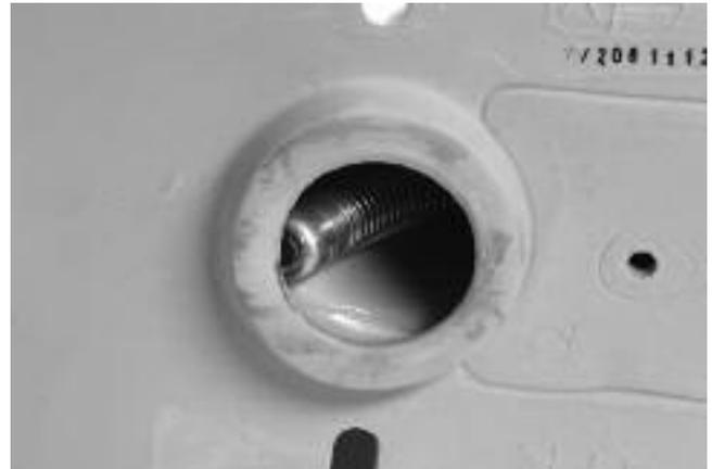
Abbildung 20 – Kamerakopf in der Wendung blockiert
