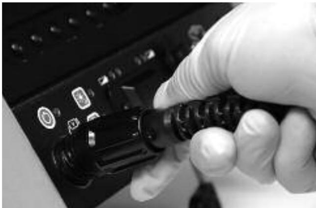
Abbildung 13 – Anschließen an eine SeeSnake CCU
