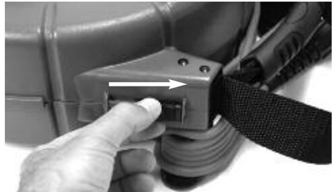
Abbildung 4 – Entriegeln des microDrain Trommelgehäuses
