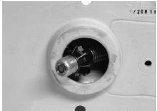
Abbildung 21 – Kamerakopf mit Kugelführung in der Wendung
