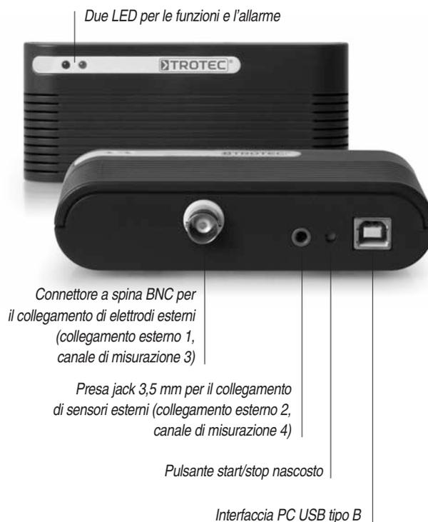
• **Quattro canali di misurazione per il rilevamento di grandezze diverse:**
