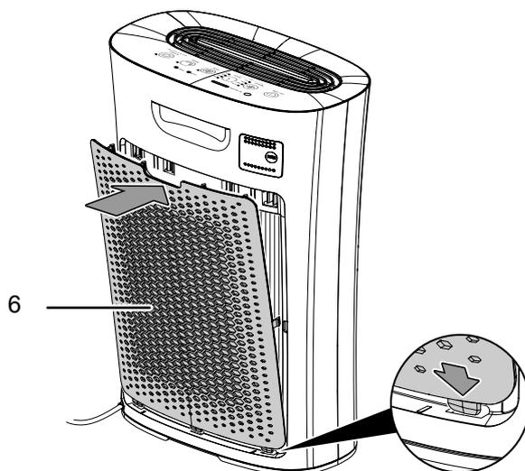
3. Nettoyez l'extérieur du pré-filtre avec filtre carbone HEPA intégré (22) avec une brosse souple ou un chiffon doux non-pelucheux. Si le pré-filtre avec filtre carbone HEPA intégré (22) est fortement encrassé, éliminez-le conformément à la législation nationale.
