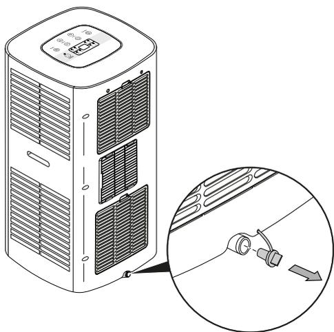
3. Collegare il tubo di scarico della condensa con lo scarico della condensa (7).
