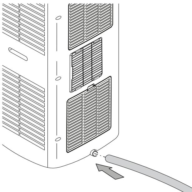
4. Portare l'altra estremità del tubo flessibile a uno scarico adatto (ad es. un pozzetto di raccolta o un contenitore di raccolta sufficientemente grande). Il tubo di scarico della condensa non deve essere piegato e non deve superare alcuna pendenza verso l'alto per arrivare allo scarico, altrimenti la condensa non può defluire.
