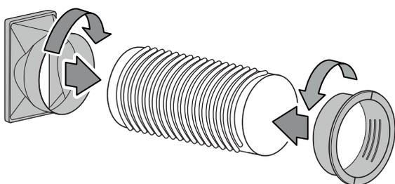
3. Inserire l'adattatore per tubi flessibili con il tubo di scarico lateralmente, nell'attacco del tubo di scarico del condizionatore.
