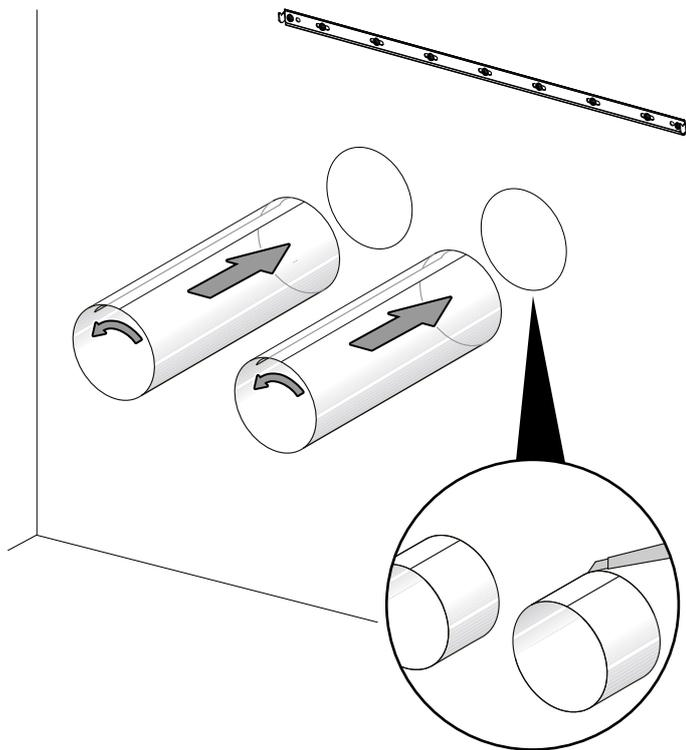
10. Posizionare l'anello di fissaggio interno della copertura dello sfiato sulla parte interna dell'apertura per lo sfiato.
