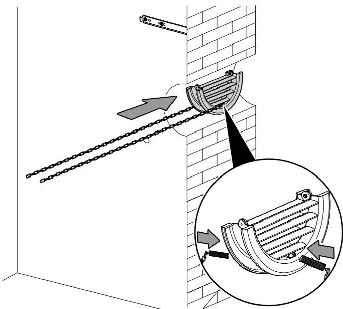
13. Aprire la copertura esterna ribaltandola, prima di fissare le catene agganciandole all'anello di fissaggio interno. Così la copertura esterna viene tenuta saldamente nella posizione.
