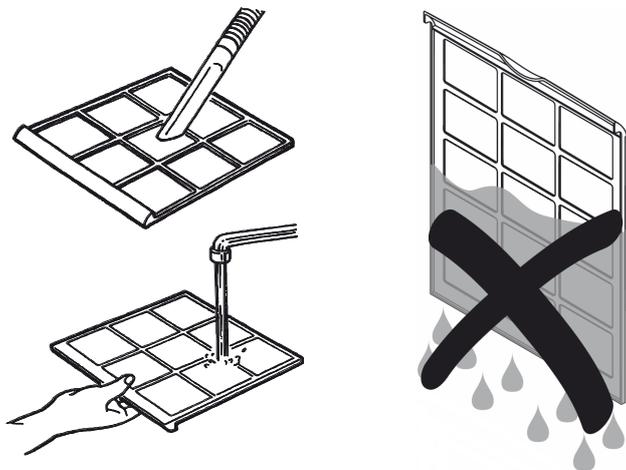
3. Far asciugare completamente i filtri. Non inserire un filtro bagnato nel dispositivo!
