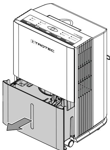
2. Premere le due chiusure sui lati del contenitore di condensa verso l'interno, per aprire il coperchio.
