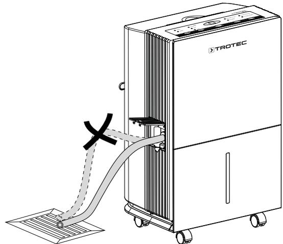
Rimuovere il tubo flessibile, se si desidera nuovamente raccogliere la condensa con il contenitore di condensa. Prima dello stoccaggio, far asciugare il tubo flessibile. Il tubo flessibile può essere allacciato per un utilizzo continuo in qualsiasi modalità di funzionamento.
