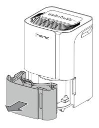
2. Entleeren Sie den Kondensatbehälter über einem Abfluss oder Spülstein.
