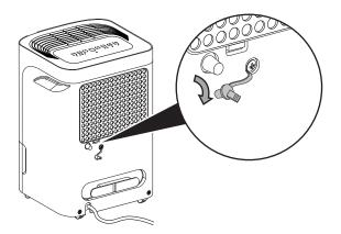
2. Schieben Sie ein Ende des Schlauches auf den Schlauchanschluss.
