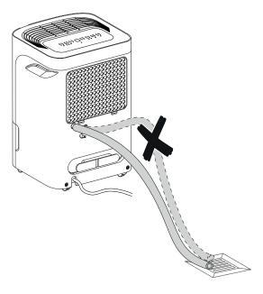
Entfernen Sie den Schlauch, wenn Sie das Kondensat wieder über den Kondensatbehälter auffangen wollen. Lassen Sie den Schlauch vor der Lagerung trocknen. Der Schlauch kann in jeder beliebigen Betriebsart zum Dauereinsatz angeschlossen werden.
