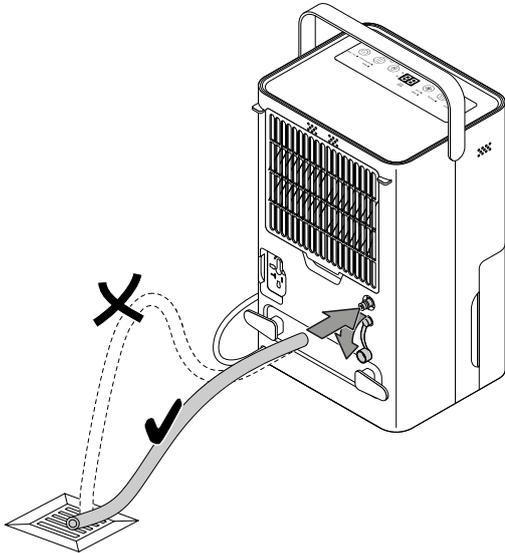
4. Entfernen Sie den Schlauch, wenn Sie das Kondensat wieder über den Kondensatbehälter auffangen wollen. Lassen Sie den Schlauch vor der Lagerung trocknen.
