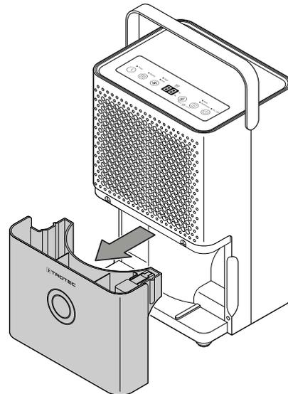
2. Entleeren Sie den Kondensatbehälter über einem Abfluss oder Spülstein.
