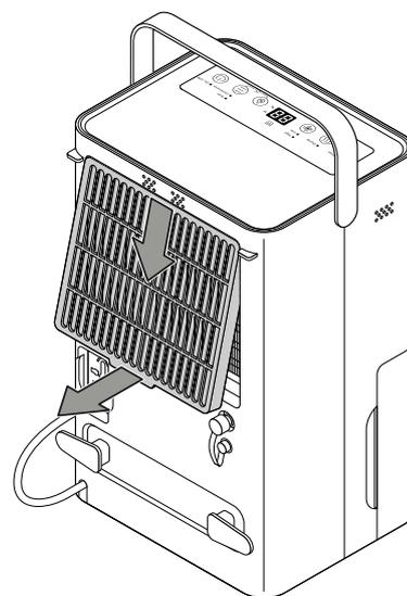
2. Säubern Sie den Filter mit einem weichen, fusselfreien, leicht angefeuchteten Tuch. Sollte der Filter stark verschmutzt sein, säubern Sie ihn mit warmem Wasser, vermischt mit neutralem Reinigungsmittel.
