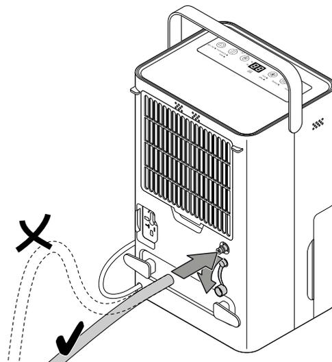
3. Führen Sie das andere Ende des Schlauches zu einem geeigneten Abfluss (z. B. Gully oder einem ausreichend großen Auffangbehälter). Beachten Sie, dass der Schlauch nicht geknickt werden darf.
