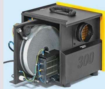
La raffigurazione in alto mostra l'interno con ruota d'essiccazione del TTR 300 Trotec. Questo deumidificatore ad adsorbimento industriale è estremamente compatto ma non è adatto per le classiche applicazioni domestiche poiché privo di contenitore per la raccolta dell'acqua.
