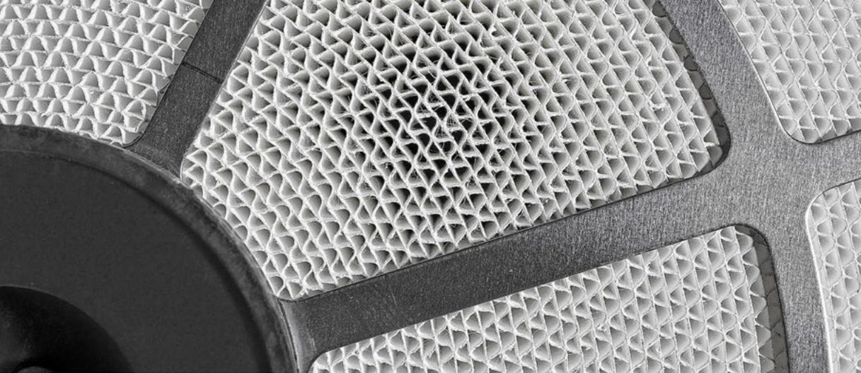
Dettaglio della ruota d'essiccazione del deumidificatore ad adsorbimento comfort TTR 57 E. Il rotore è rivestito con Silicagel, un essiccante con una superficie igroscopica estremamente grande. Nei gruppi di deumidificazione ad adsorbimento professionali un grammo di questo essiccante copre una superficie di oltre 700 metri quadrati. Meno di 10 grammi sono sufficienti quindi per una superficie estesa come un campo da calcio.
