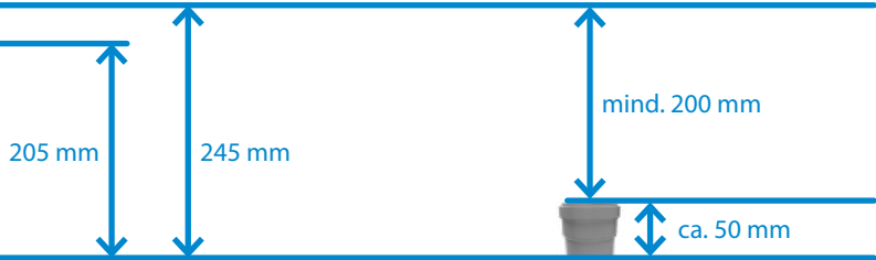
(1) Ablauf automatische Spüleinrichtung; (2) Zulauf automatische Wasserzufuhr (AWZ) Abb. 8.3.1: Maßzeichnung für Wasseranschlüsse
