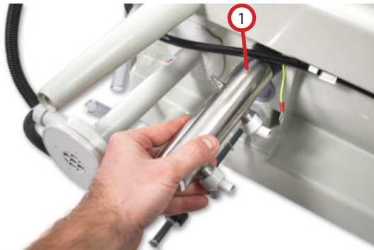
Abb. 8.1.2.5: Gehäuse UV-Entkeimung entfernen
